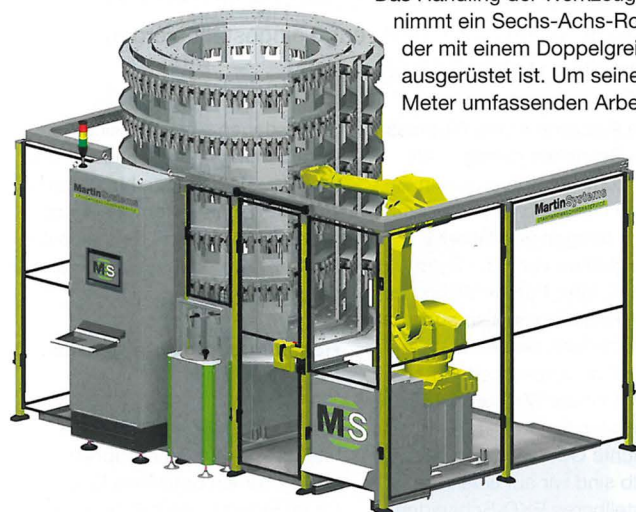
Bild: 780 Werkzeuge kann der Speicherturm auf einmal verwalten und handeln (Werkbild: MartinSystems GmbH, Nagold)
