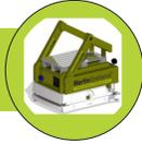
Der Mechafant ist ein autonomer mobiler Roboter (AMR), welcher sich für Nutzlasten bis zu 800kg eignet. Er ist für den Einsatz in Umgebungen ausgelegt, in denen sich Menschen bewegen und unerwartete Hindernisse auftreten können.
