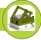
Dank den hydraulisch angetriebenen Gabeln ist der AMR in der Lage ganze Europaletten direkt vom Boden aufzunehmen und wieder abzustellen. Während des Transports von einer beliebigen Abholposition A zu einer beliebigen Abgabeposition B wird die Europalette auf der Ladefläche des Transporters aufgesetzt.
