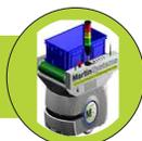
Der Transporter ist ein intelligenter, autonom fahrender Roboter (AMR), welcher sich in dieser Größe für Nutzlasten bis zu 90kg eignet.
